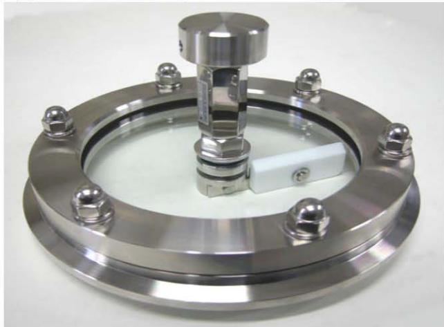
ワイパー付視窓: WWB-135-10 有効視径: \phi 125 仕上: 機械加工肌 ヘルール: ISO-6. 5S(6S) 重量: 約3kgf
